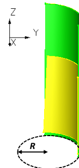
図 3 z 軸を中心軸とした折り曲げ
